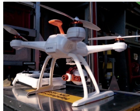
Im Projekt Micro Rapid Mapping geht es um die extrem schnelle Erkundung einer Einsatzstelle. Dazu muss eine Feuerwehr-Drohne (oben) in der Lage sein, die großen Datenmengen per Funkstrecke an einen Prozessrechner im Einsatzleitwagen (ELW) zu übermitteln. Während der Kopter noch fliegt, werden die Bilder automatisch verarbeitet (unten).
